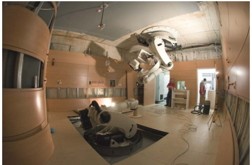
Patientenraum des Horizontalstrahlplatzes mit dem "Patienten"-Roboter an der Decke. Weitere Anlagen sind zur Zeit an den Universitäten Marburg und Kiel sowie in Parma/Italien und Shanghai/China im Bau.
