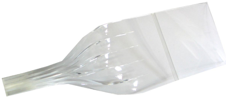
Bild 1: HEST Szintillator mit Klebeverbindung und quadratischem Querschnitt
